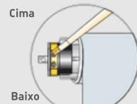
B. Ajuste o botão "CIMA" para configurar a posição de limite do ponto alto
