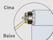
B. Ajuste o botão “CIMA” para configurar a posição de limite do ponto alto
